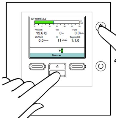
Appuyer **simultanément** sur le bouton alarme et la flèche du bas jusqu'au double bip sonore.
